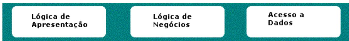
**Figura 1 – Exemplo de Camada Monolítica, onde todas as operações são feitas em uma única camada**
