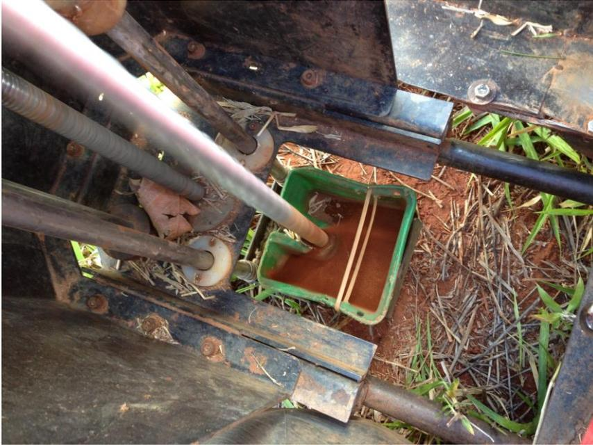
**Figura 3** – Broca equipada no quadriciclo, perfurando o solo para obtenção das amostras.
