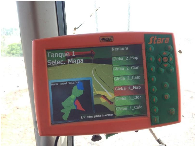
**Figura 7** – GPS com o “grid” contendo todas as informações necessárias para distribuir os insumos no solo.
