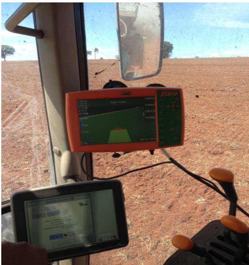
**Figura 8** – GPS em utilização na distribuição de insumos com taxa variável. Na tela superior, a parte mais clara identifica a área já distribuída e a parte escura, a que ainda será distribuída.
