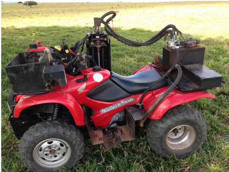
**Figura 1** – Quadriciclo equipado com GPS e broca para perfurar e coletar amostras do solo.
