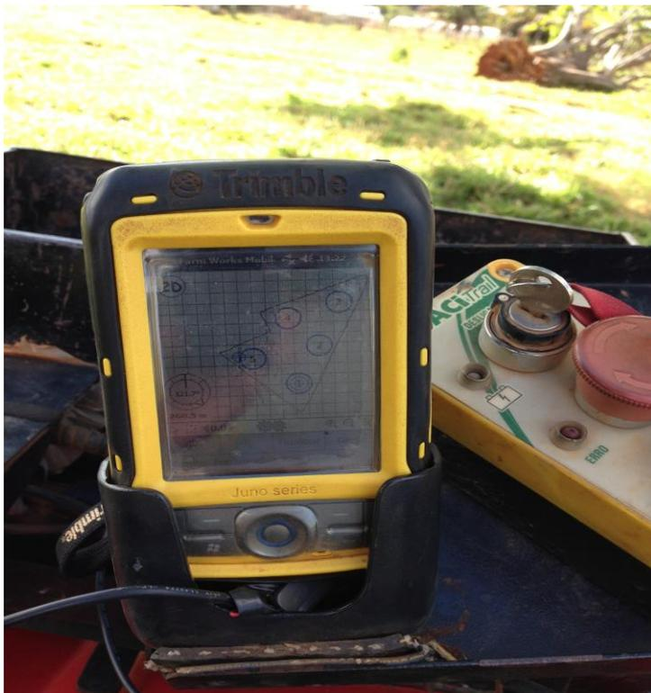
**Figura 2** – GPS do quadriciclo, com a delimitação da área e os pontos a serem coletados.
