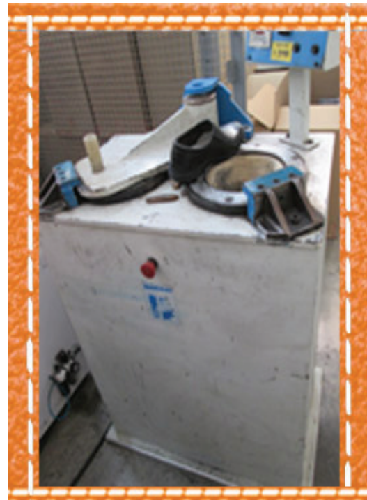
Máquina sorveteira, responsável pelo formato da ponta do sapato.
