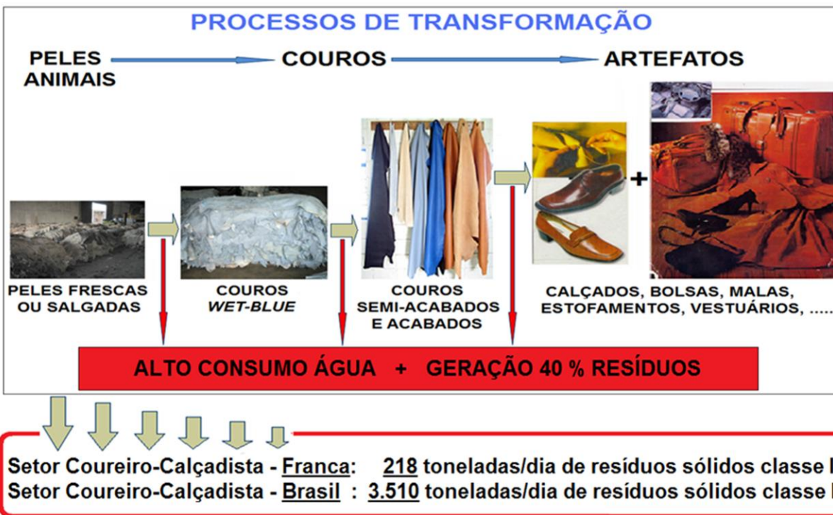
Figura 1. Quantidade de resíduos gerados durante os processos de transformação de peles em couros, e de couros em calçados e artefatos (FÉLIX DE SOUSA, 2009).
