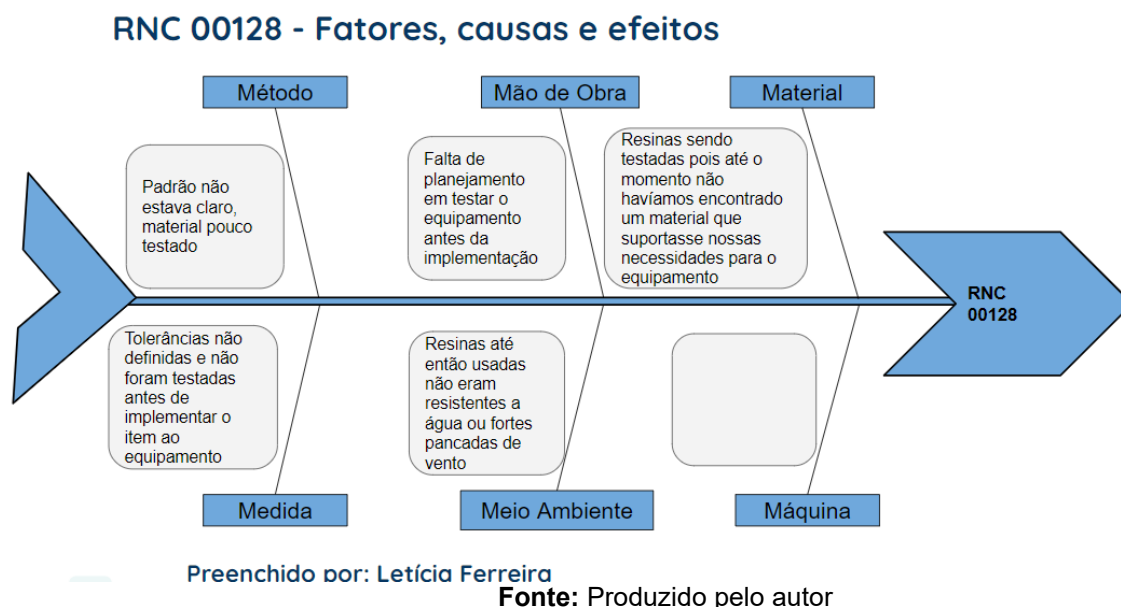
Figura 6 - Diagrama de Ishikawa utilizado para analisar todas as possíveis causas da Não conformidade ou investigação aberta, realizando uma análise mais profunda.
