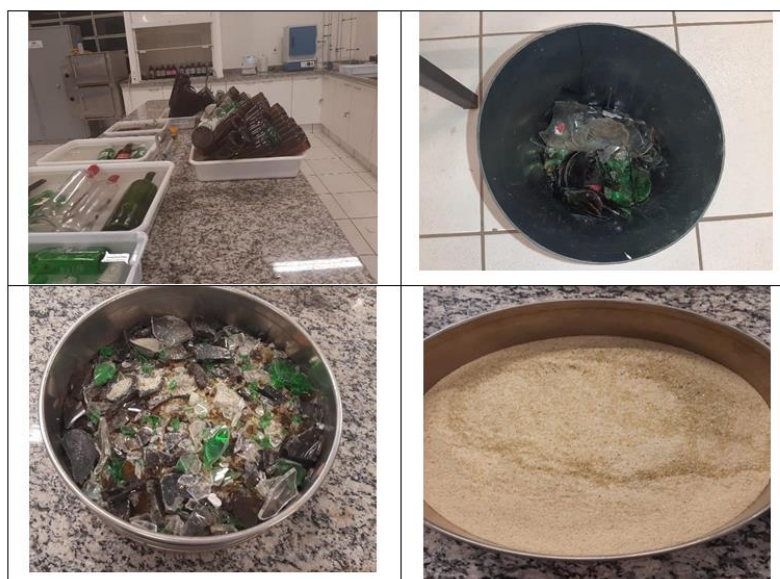
Figura 5: Processo de lavagem, secagem e maceração do vidro.
