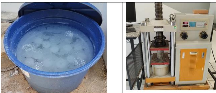
Figura 7: Cura e ensaio de compressão
