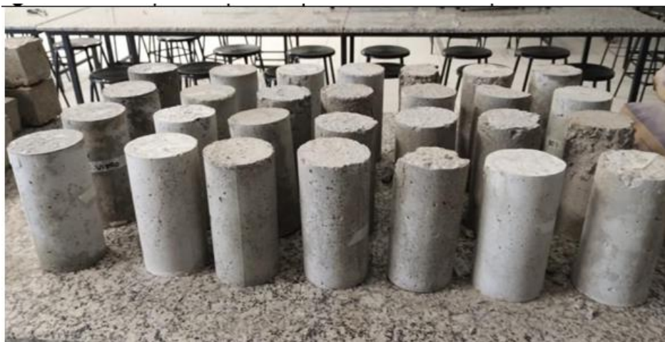
Figura 8: Corpos de prova após ensaio de compressão
