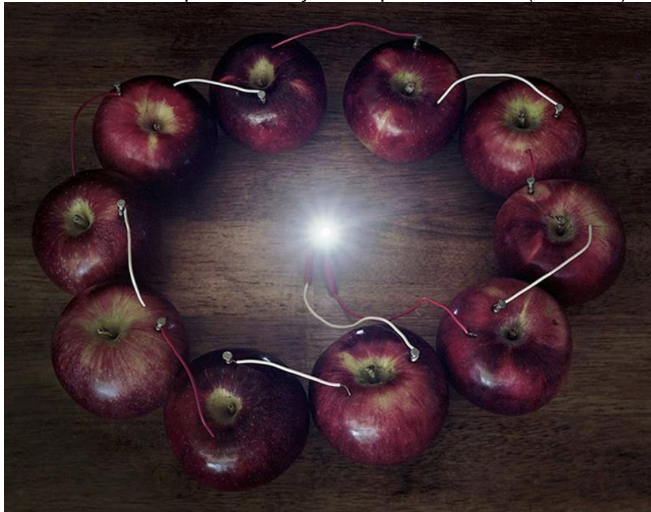
Figura 4 – Circuito de pilha de maçãs: lâmpadas de LED (três volts) acesa.
