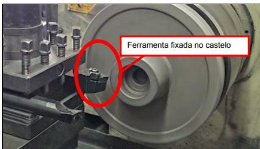
Figura 5 – Porta-ferramentas do torno.
