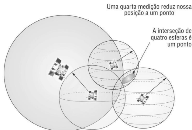
Figura 7 – Exemplo de intersecção de esferas imaginárias
